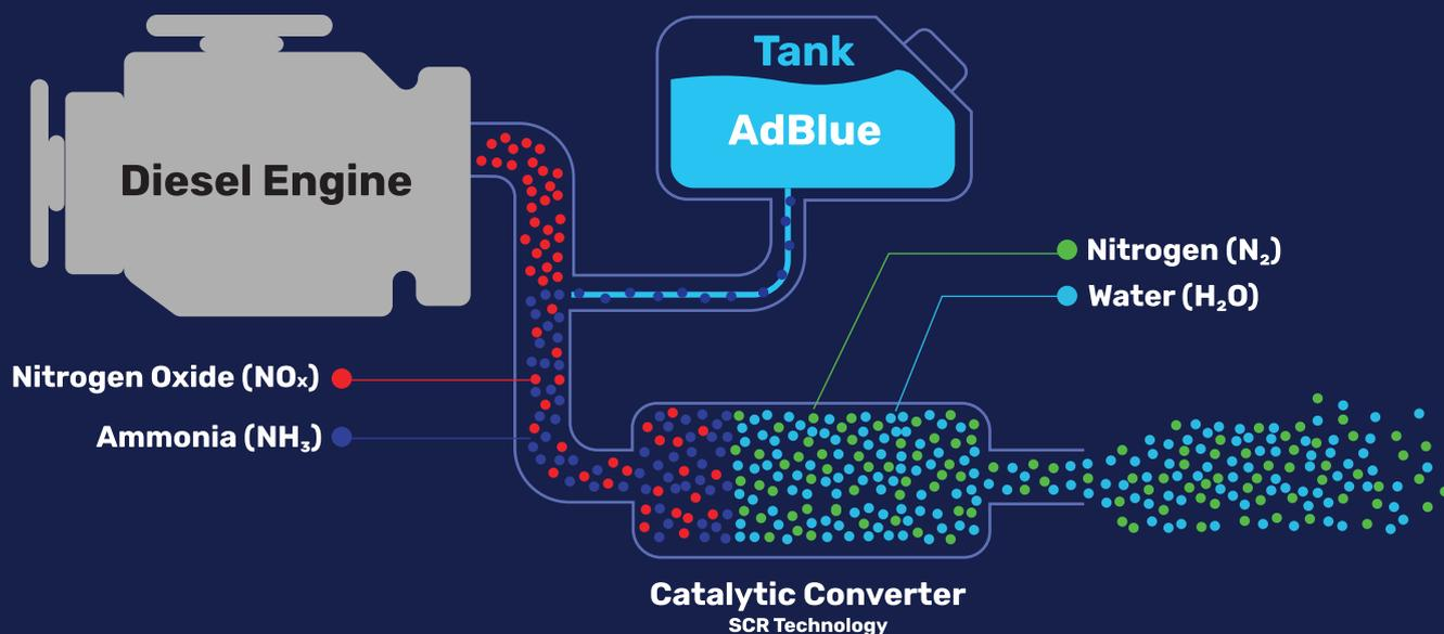
Водний розчин сечовини, в даному випадку AUS32 AdBlue®, вприскується у гарячий вихлопний газ, що відпрацював і піддається гідролізу при температурі понад 180 °C з утворенням аміаку і вуглекислого газу. Далі аміак взаємодіє з оксидами азоту (NO + NO<sub>2</sub>) в присутності каталізатора системи SCR-пентаоксиду ванадію (V<sub>2</sub>O<sub>5</sub>) з утворенням повністю нешкідливих компонентів атмосферного повітря: елементарного азоту (N<sub>2</sub>) та води (H<sub>2</sub>O).
